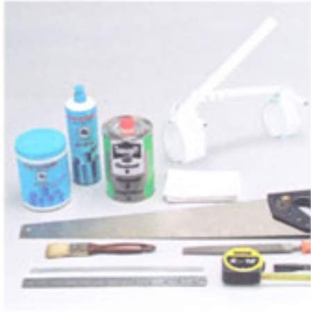
1. เครื่องมือและอุปกรณ์ประกอบที่ใช้ในการต่อประกอบท่อ เช่น ปากกา เลื่อย ตลับเมตร ตะไบ น้ำยาทำความสะอาดท่อ ผ้า น้ำยา Pipe Lube และ Puller
