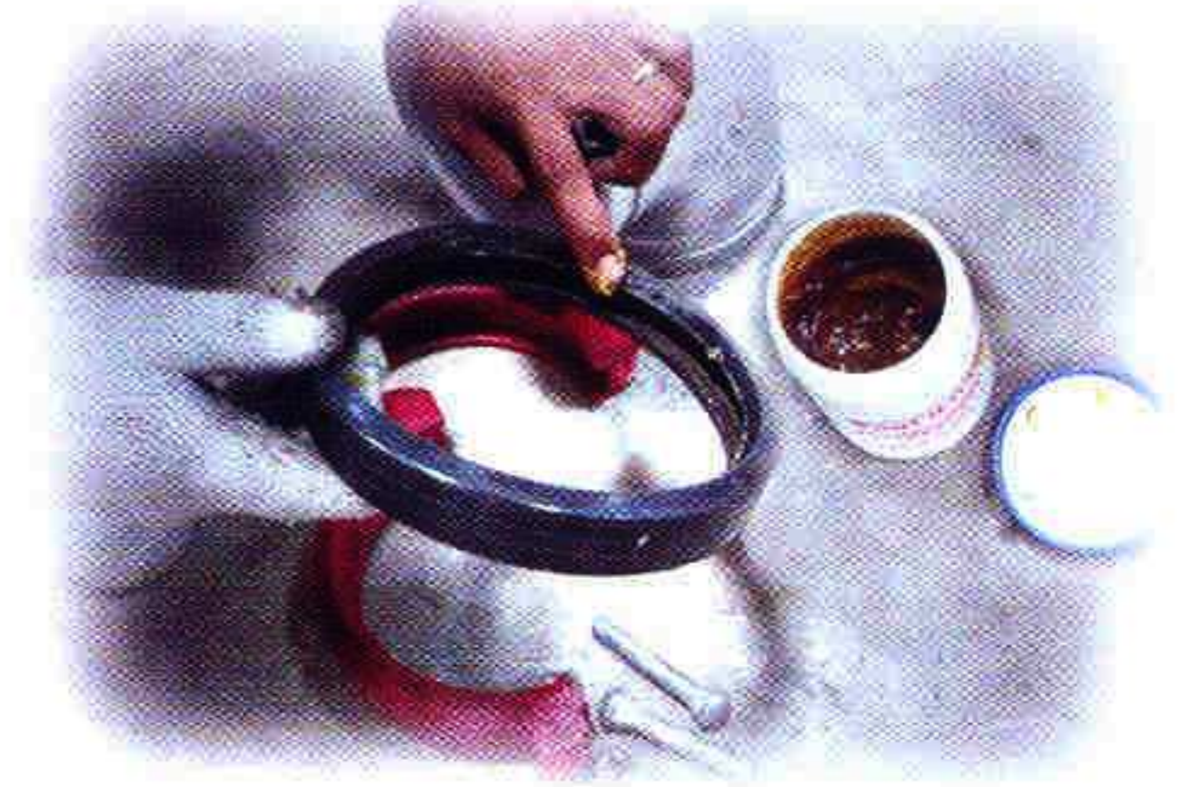
2.3 ทาน้ำยาหล่อลื่น Lubricant ที่ขอบยาง เพราะหน้าตัดท่ออาจมีคมของเหล็กทำให้ยางเกิดเป็นรอยแผลขนแมวเล็กๆ อายุการใช้งานจะเสื่อมลง การทา Lubricant จะช่วยยืดอายุการใช้งานของยางให้ยาวนานขึ้น
